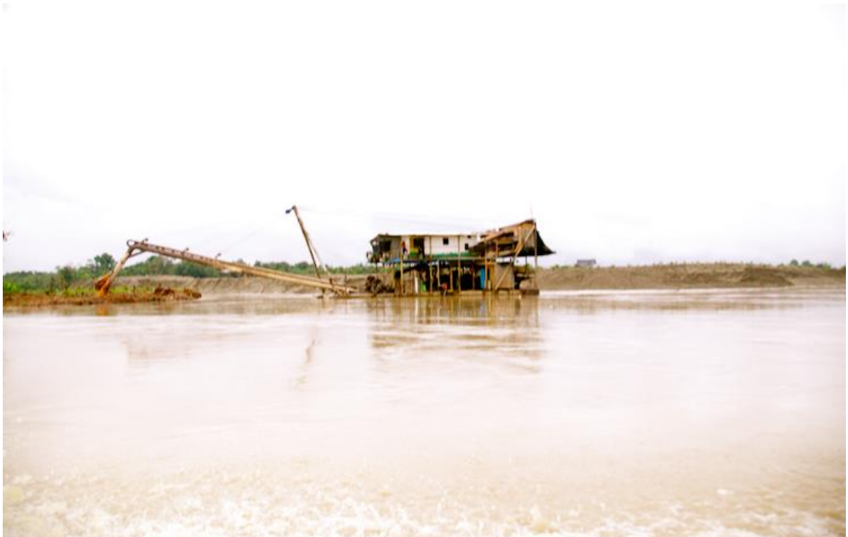
Folio 2114 del Cuaderno de pruebas Núm. 5. Draga o “dragón” -como los denominan las comunidades locales- realizando actividades de remoción de arena en el lecho del río Quito (afluente del Atrato). Enero 29 de 2016.
